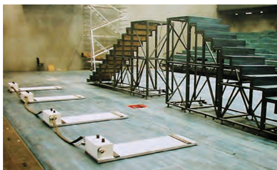
テフロンコーティングを使用した 劇場の座席移動装置
