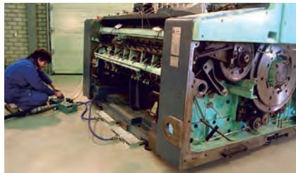
エアを供給、圧力を調整し機械を上昇させる
