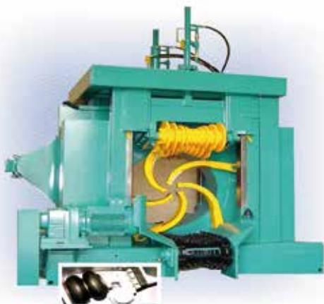
Descortezadora de troncos / Knife spring for wood machinery
