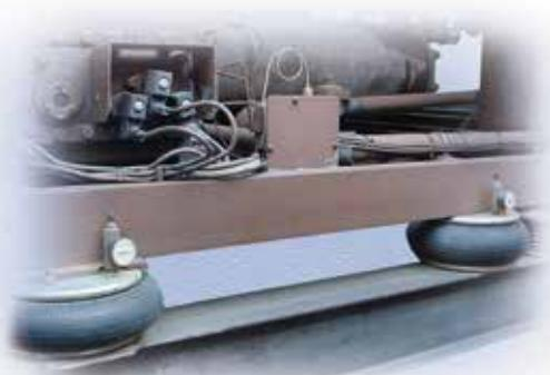
Amortiguadores para grandes compresores / Large compressor isolator
