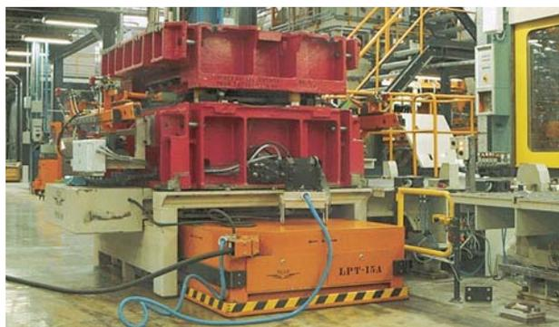
金型変換システムトランスポーター 10トン
