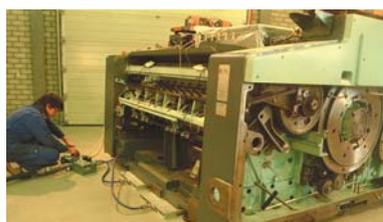
エアを供給、圧力調整し機械を浮上させる
