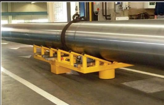
リモートコントロールモデルを使用した超大型配管(20t)の搬送
