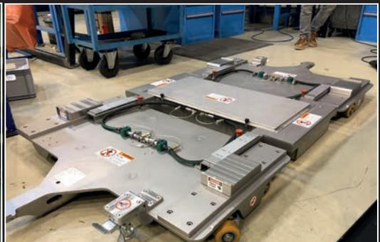
タンク専用昇降台車はフレーム両端に伸縮レールを装備し、3つの異なる幅のタンクに対応可能です。また床面から最大170mmまで昇降し、昇降は無線で遠隔操作可能です。
