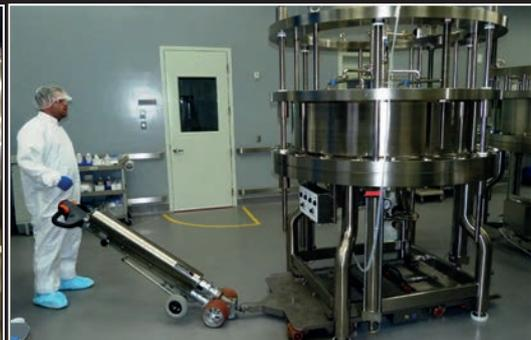
化学工業向けタンク専用昇降台車+パワーアタックを使用したタンク(最大20t)の搬送
